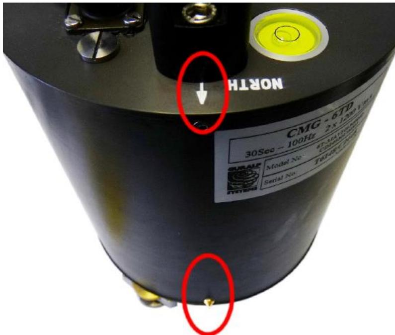
4. Reemplace el tornillo de alivio de presión en la tapa. Este tornillo incorpora un sello tipo 'O'-ring': no apriete demasiado o dañará el 'O'-ring'.
