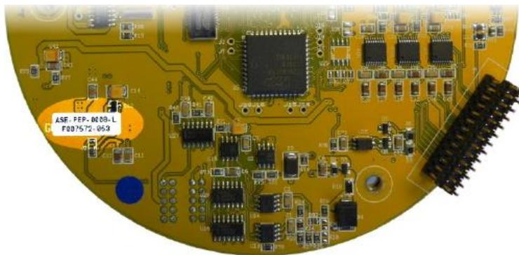
2. Identifique la ubicación de J5 en el borde de la placa del procesador. Dependiendo de la construcción exacta del instrumento, puede haber o no un conector instalado en esta posición.
