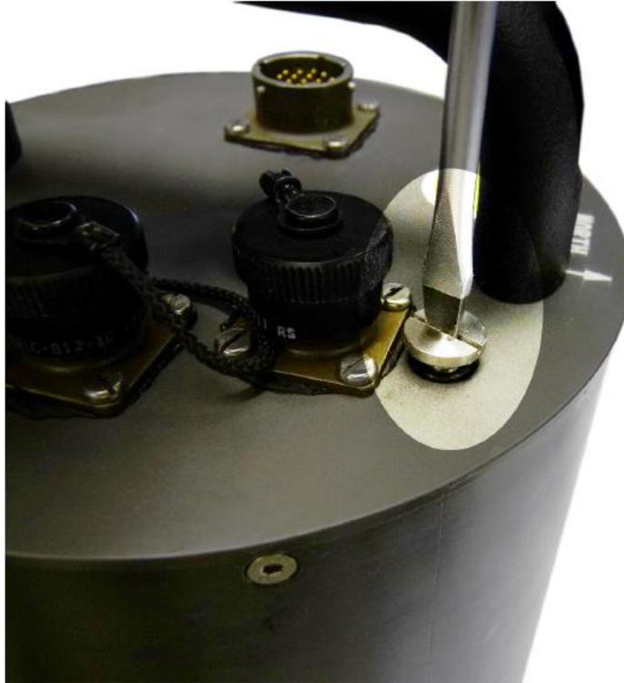
3. Retire la tapa sujetando la carcasa exterior de forma segura mientras tira suavemente de la empuñadura con un ligero movimiento de balanceo. Tenga en cuenta que hay una pila de PCB sujeta a la parte inferior de la tapa: no permita que golpeen el interior del tubo cuando se retira la tapa.
