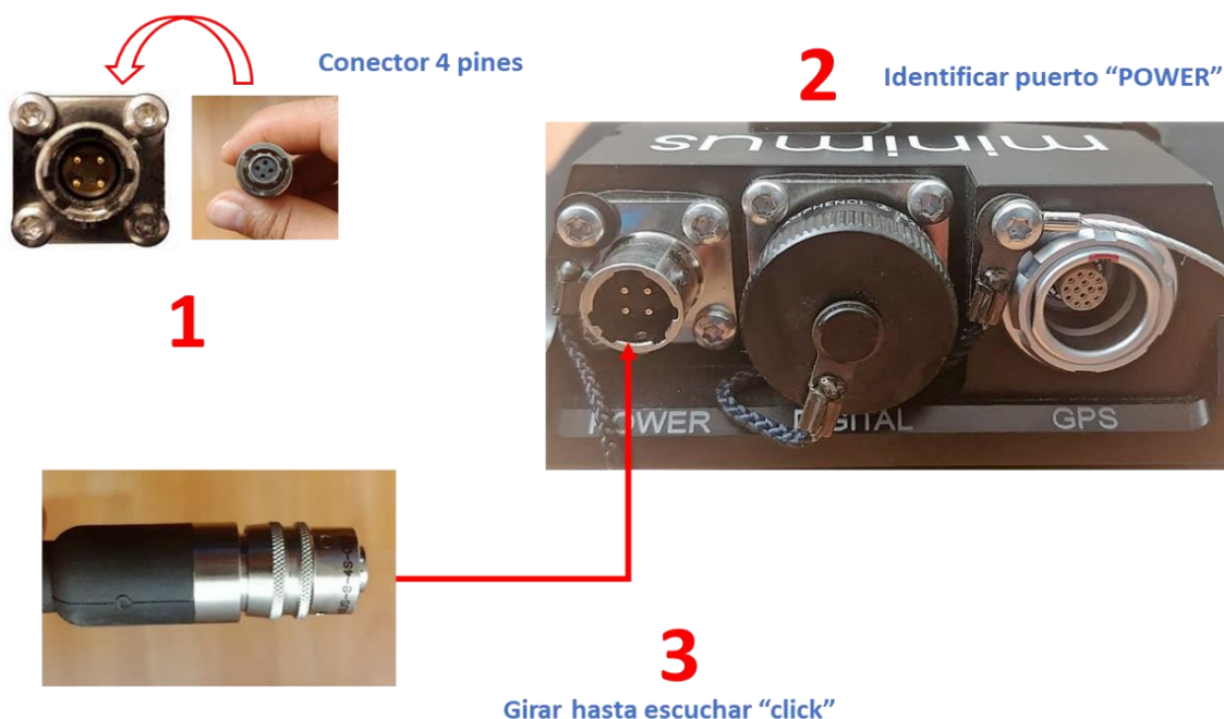
Figura 1. Conexión del cable de alimentación para el Minimus.
