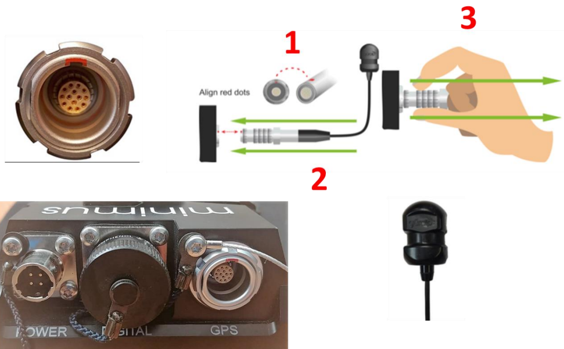
Figura 2. Conexión antena GPS al Minimius.
