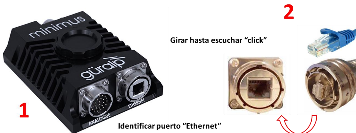
Figura 3. Conexión del cable de red con cobertura tipo militar.
