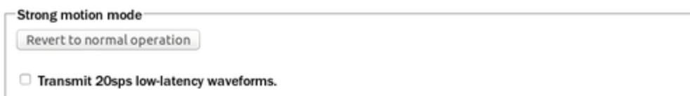
La casilla de verificación "Transmitir 20sps de baja latencia" habilita o deshabilita las 20 muestras por segundo de flujo, que se utiliza internamente para proporcionar los datos para los cálculos de movimiento fuerte pero también se puede transmitir, grabar y usar como cualquier otra salida corriente.
